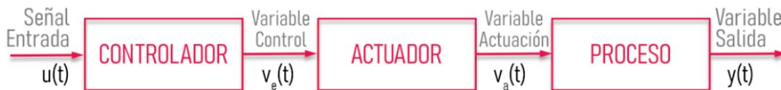
*Figura 4-18.- Sistema de Control en bucle abierto*
