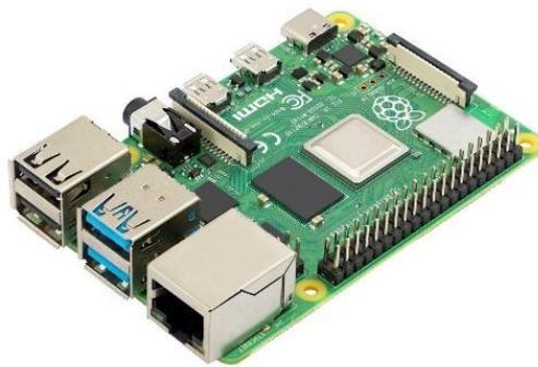
Figura 3-3. Raspberry Pi 4 Model B
