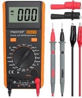
Figura 2-12. Medidor LCR
