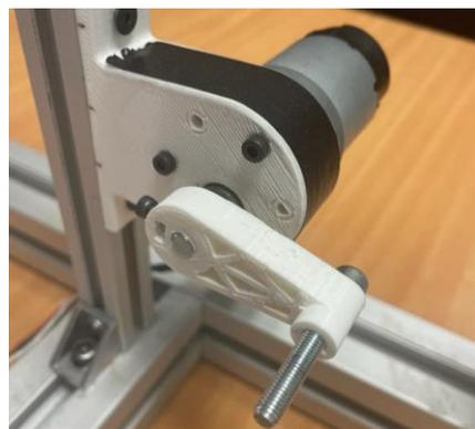
Figura 3-15. Brazo del motor
