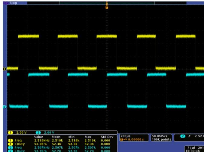
Figura 3-2. Salidas del encoder vistas en un osciloscopio
