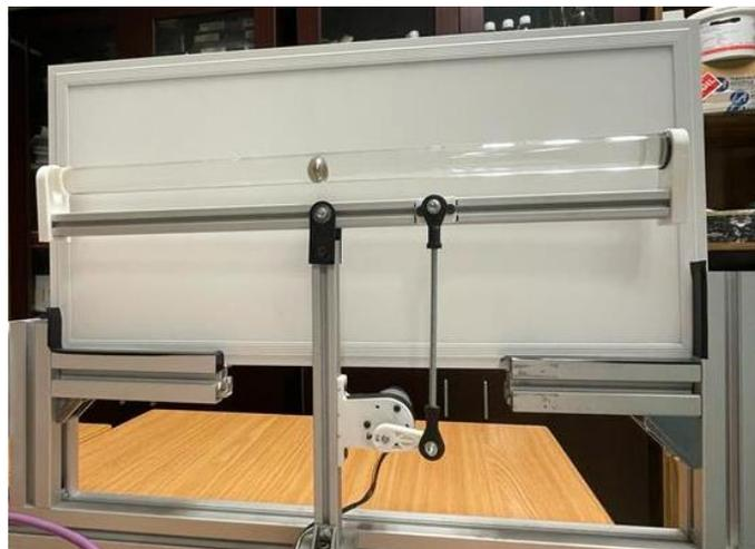
Figura 3-17. Unión del motor con la barra
