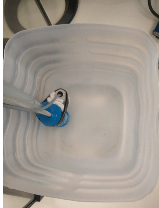
Ilustración 58. Bomba de Agua y Sensor de Nivel
