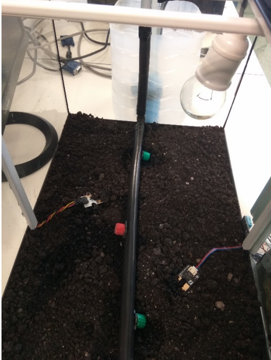
Ilustración 59. Sensores de Humedad y Sistema de Riego
