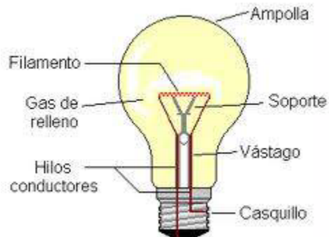
Ilustración 27. Partes de una bombilla
