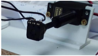
Ilustración 13: Potenciómetro acoplado al servomotor
