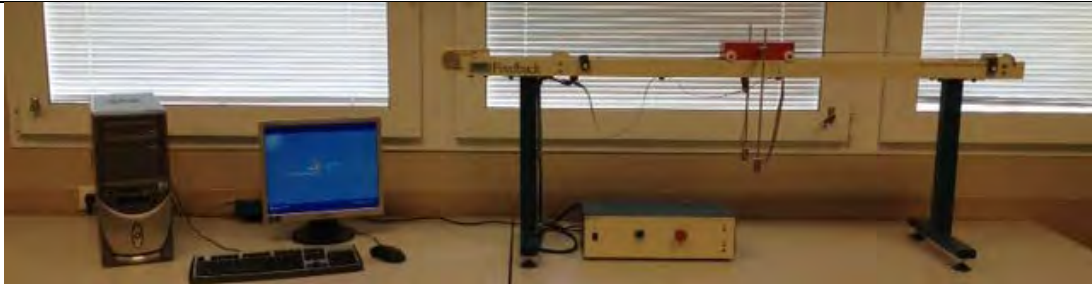
Figura 12. PC servidor con Sistema de péndulo invertido sobre carro de trayectoria lineal
