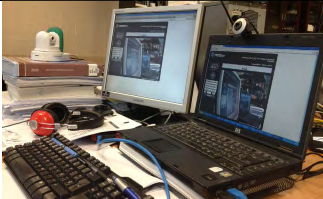
Figura 14. Uso de la cámara IP TrendNET TV-IP410 de forma local.
