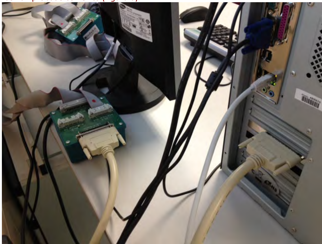
Figura 5. Vista trasera del PC con detalle de las conexiones de la tarjeta de E/S.
