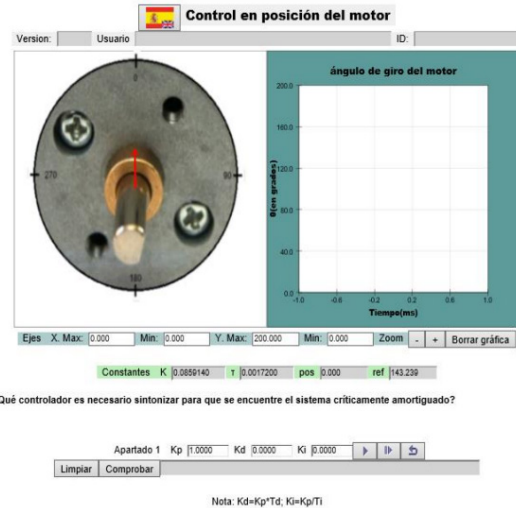
Fig. 5. Captura parcial de la GUI del laboratorio virtual de control en posición.
